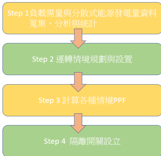
圖 2 多重微電網聯絡開關配置求解流程
